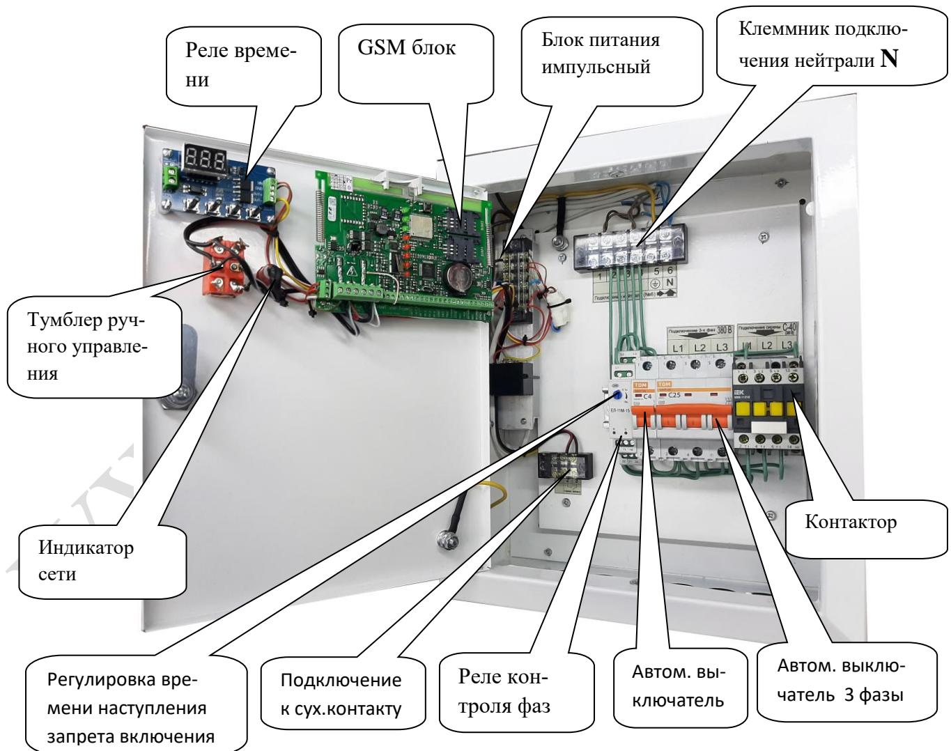
Блок управления сиреной БУС-7 gsm выполнен в металлическом ящике. На дверце расположен тумблер принудительного включения-отключения сирены и индикация наличия 220 вольт. Сверху расположена антенна GSM (возможны варианты). Подвод кабелей снизу ящика. Нагрузкой управляет контактор электромагнитный. SIM карта находится в держателе GSM блока. Питается устройство от импульсного стабилизированного блока питания  $12 \pm 5,0\%$  вольт.
